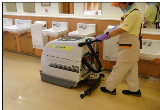
この機械の中に洗剤と水を入れると、床に散布され、底面にあるポリッシャーで円を描くように擦っていく。最後に足元（黒くて細い部分）で污水を吸い取るので、水は残らない。
