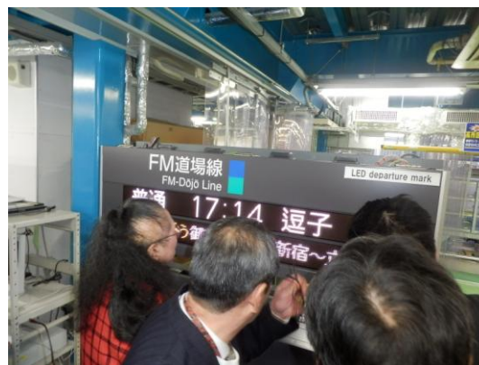
馴染みのあるあの電光掲示板。今は LED で表示。白色に見える部分は、目を近づけて見ると、3 色（赤・青・黄）で構成されている。また発熱も少なく、低コスト。
