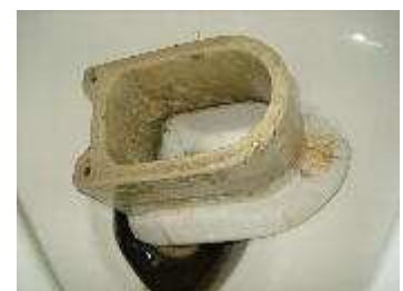
トラップの二重構造の中の尿石取りはどうしたらよいか？
